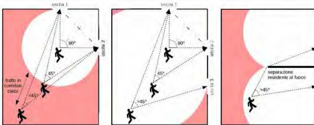
Vie d'esodo orizzontali e uscite **indipendenti, corridoio cieco** (area campita), uso di separazione resistente al fuoco per rendere indipendenti 2 vie d'esodo.
